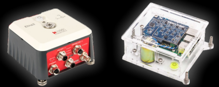
Exemple de accelerometre folosite de INFP pentru monitorizare structurală: Etna2 (Kinematics) sau 4D (RaspberryShake).
